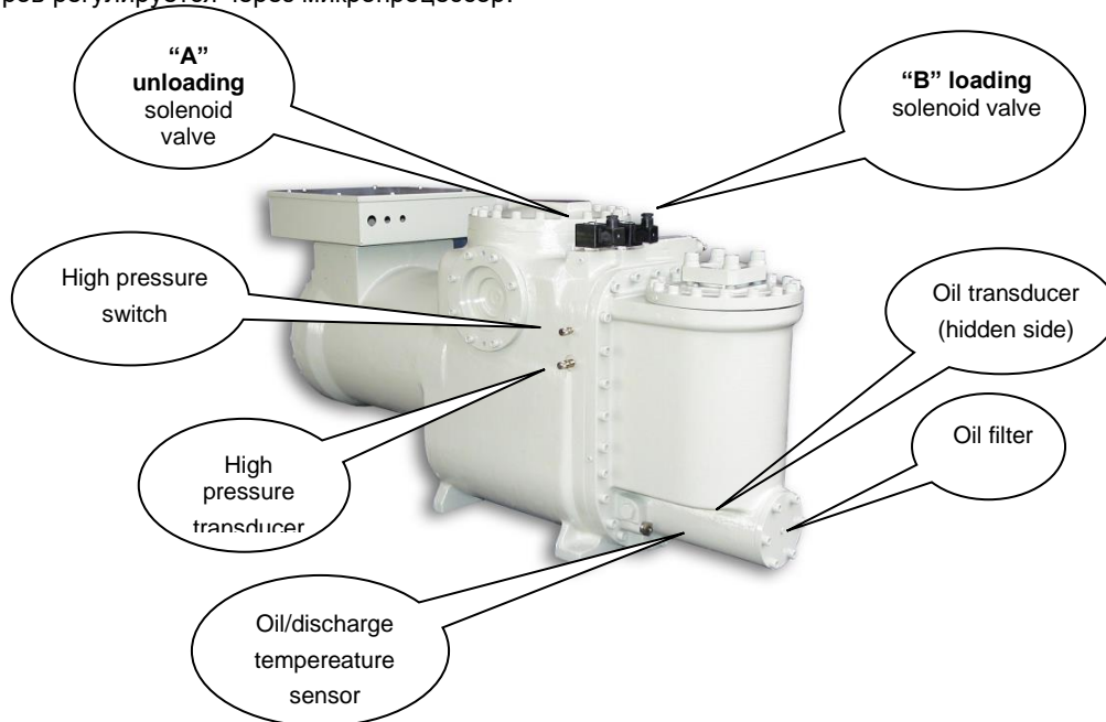
Рис. 32 - установка устройств управления для компрессора Fr3100
