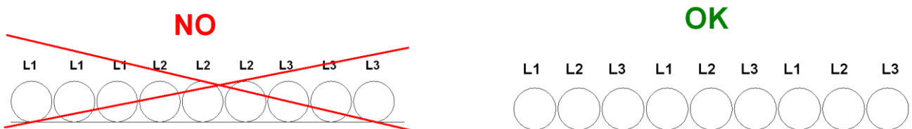
Рис. 17 - прокладка проводов питания большой длины
